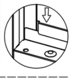
Monter bundpladen, og fastgør derefter skillepladen i henhold til markeringerne.
