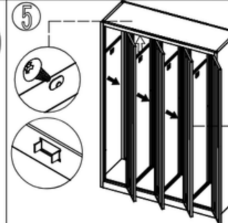
Monter toppplaten, og fest deretter skilleplaten som angitt.
